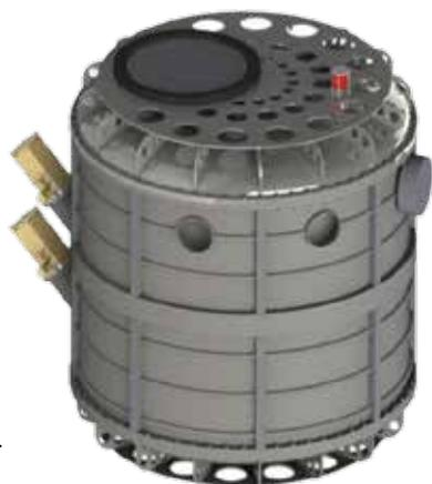
Carcasa o envoltura externa del detector.
